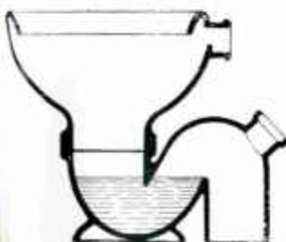
Cuvette et siphon en deux pièces à chasse directe avec tubulure de ventilation Siphon 1/2 porcelaine unie
