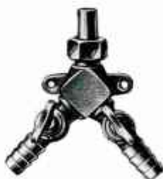
N° 2300 Nourrice à patte à 2 robinets de 8 3 / 16 à écrou Tubulure en laiton recuit de 40, 50, 60, 70, 80, 90 3 / 16 et 1 m
