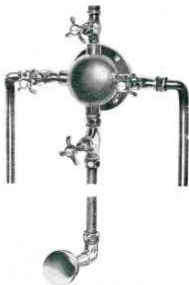
Fig. 522 Mélangeur à 4 robinets, boule de 12 m combiné pour alimentation d'une baignoire par mascaron. Raccords 20×27. Colonne de 22. Pomme de 140. Collier de fixation.
