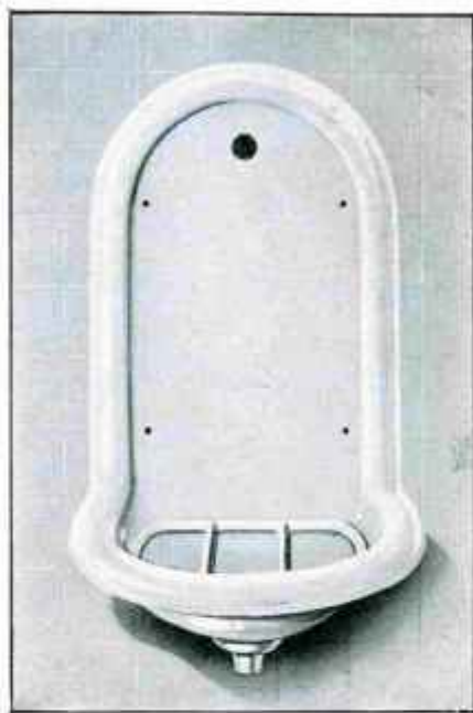
N° 104. — Un trou de robinet. Modèle à dos plat, cuvette 1/2 ronde. Bonde siphonée. Hauteur totale : 69 cm Largeur : 41 cm Saillie : 30 cm
