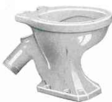
Fig. 306 L. - Cuvette avec siphon apparent pied carré, sortie oblique. Poids : 11 kilog. Inclinaiion de la sortie : 45°.
