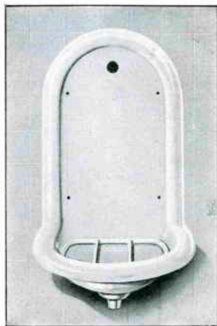
N° 104. — Un trou de robinet. Modèle à dos plat, cuvette 1/2 ronde. Bonde siphonée. Hauteur totale : 69 1 / 16 Largeur : 41 1 / 16 Saillie : 30 1 / 16
