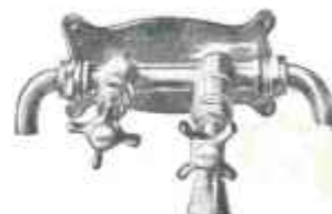
Fig. 462 PLAQUE DE ROBINETTERIE avec robinets applicables, à raccords, pour eaux froide et chaude, orifice de 16%. Spéciale pour chauffe-bains au bois, à écoulement libre.
