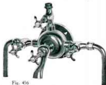
Fig. 456 Douche en pluie, tube de 22 montée sur nourrice ronde, donnant eau chaude, froide ou mélangée, à la baignoire ou à la douche à 3 ou 4 robinets. Petit modèle nourrice de 7 m , saillie 16 m Grand — — 12 m — 17 m,5 Raccords en 20/27. Pomme de 140.
