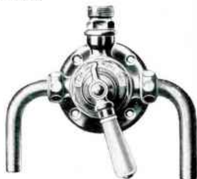
Fig. 476. — Robinet mélangeur pour douche donnant à volonté l'eau froide, l'eau mélangée ou l'eau chaude. Arrivées et départ 20 × 27
