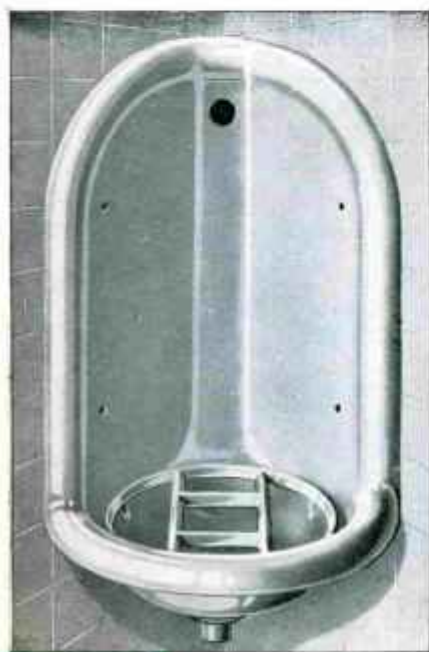
N° 101. — Un trou de robinet. Modèle à dos plat, cuvette rectangulaire. Bonde siphonée. Hauteur totale : 67 1 / 16 Largeur : 39 1 / 16 Saillie : 30 1 / 16
