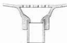
Coupe du départ direct et du tube fer fileté N° 401 - 404 - 422
