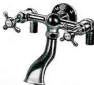
Fig. 459 Mélangeur à 2 robinets, bec plat. Raccords en 20 x 27. Saillie : 16 mm. Douilles à souder ou filetées au pas des tubes fer.
