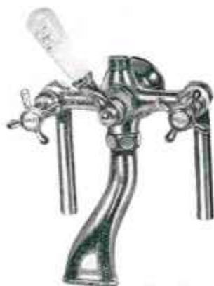
Fig. 455 Mélangeur à clapet, bain et douche commandés par une seule manette porcelaine. Raccords : 20×27 Saillie : 19 m
